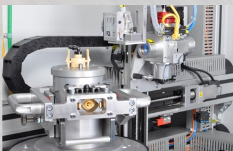
Detail procesní hlavy na motorizovaném pojezdu YZ, v provedení s pyrometrickým měřením teploty v místě sváru a měřením výkonu laseru. Přípravek s přítlačnou maskou pro 2D svařování dílu v rovině XY.
