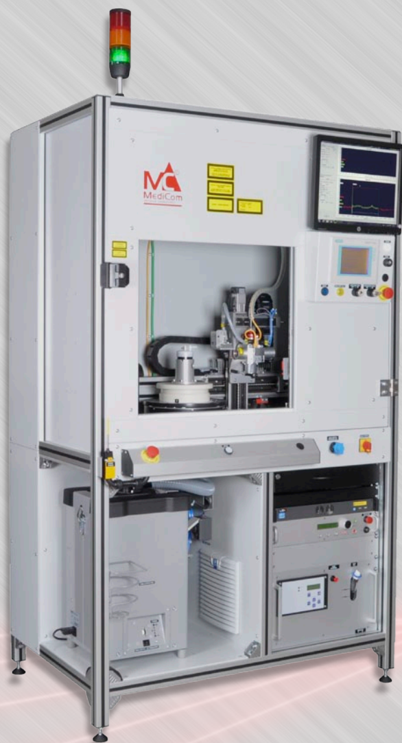
Stanice AWW osazená laserem 200 W / 980 nm. Vodou chlazený laser včetně veškerého příslušenství je integrován jako součást stanice.
