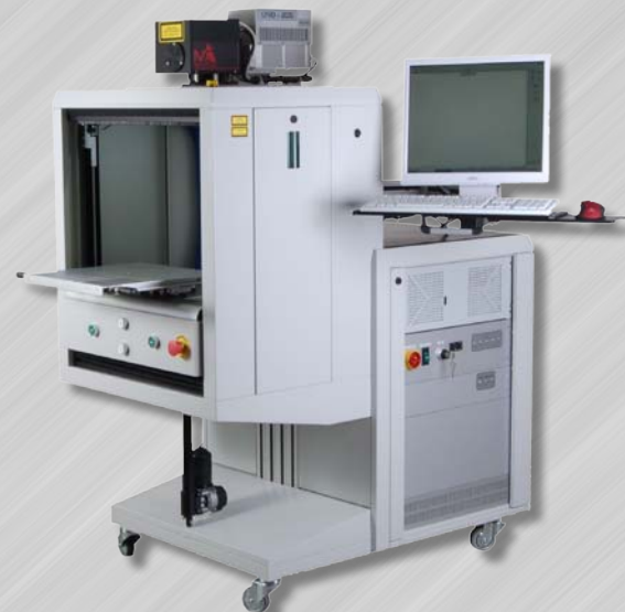
Popisovací stanice s vanadátovým laserem v provedení s výsuvným stolem a motorizovanou žaluziovou roletou.
