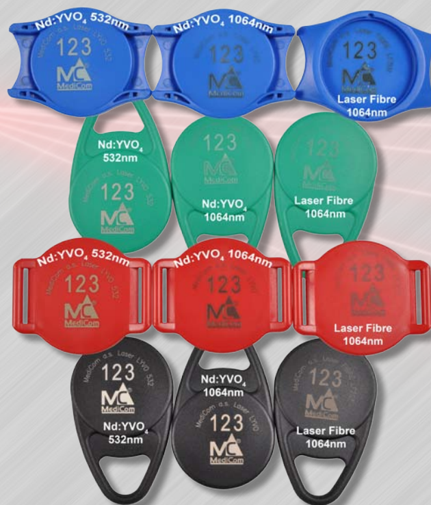
Porovnání nejlepších dosažených popisů kritických plastů lasery Nd:YVO 4 532 nm, Nd:YVO 4 1064 nm a Fibre laser 1064 nm.
